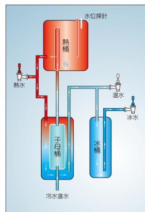
採用無壓式溫熱交換式熱桶, 超高溫煮沸再冷卻出水, 如下圖示
